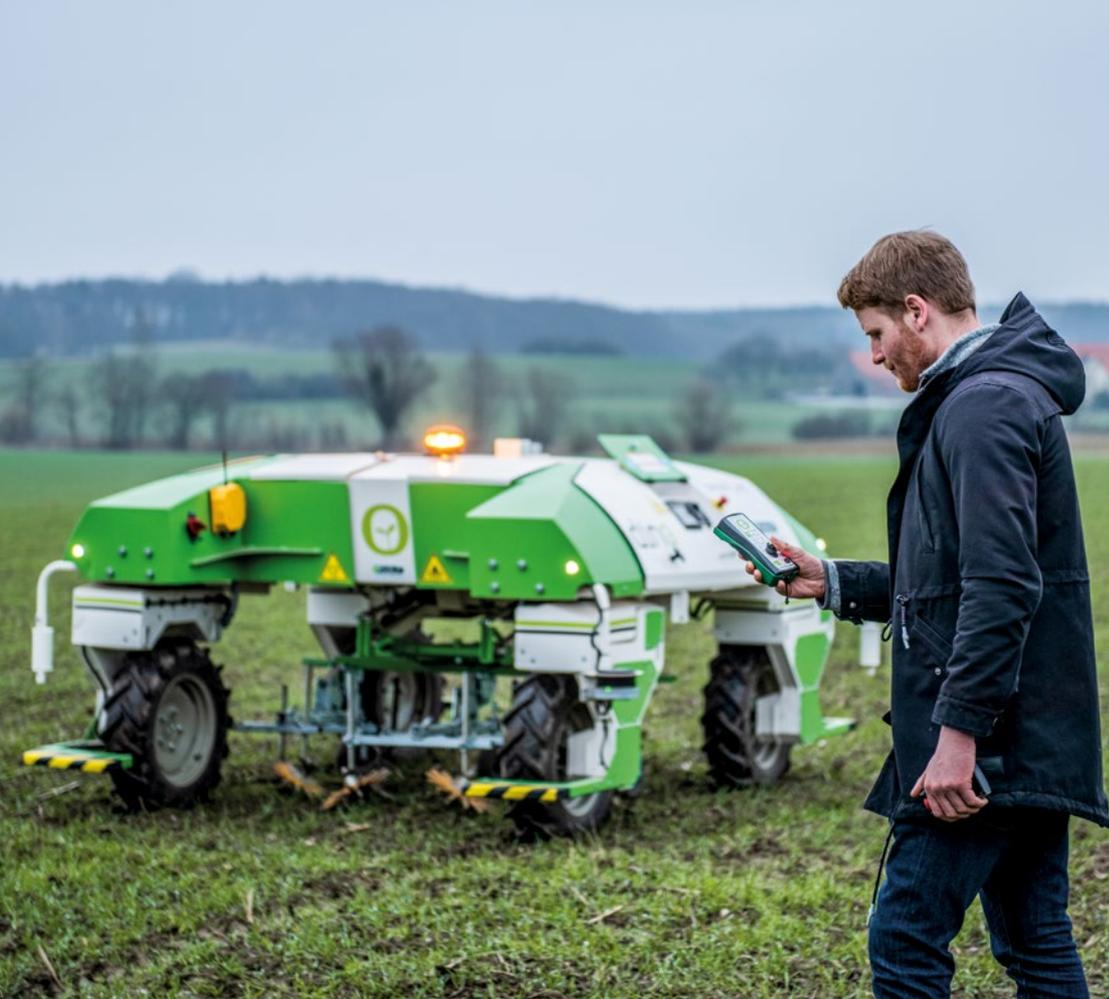
Der autonome Roboter »Dino« der Hochschule Osnabrück wird zur mechanischen Regulierung von Unkraut eingesetzt. Mit einer Fernsteuerung lässt sich der Roboter bedienen.
